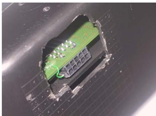
10 Collegare il connettore a 10 pin, proveniente dal cavo fornito col kit Plancia Geosat col connettore alla base della plancia
